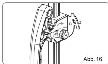
2. Entriegeln Sie den Griff, heben Sie das Gehäuse an, indem Sie die Hand nach oben ziehen, bis ein "Klick"-Geräusch ertönt, und verriegeln Sie dann den Griff (Abb. 17-19).
